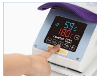
5 Nastavite čas tiskanja in temperaturo;
