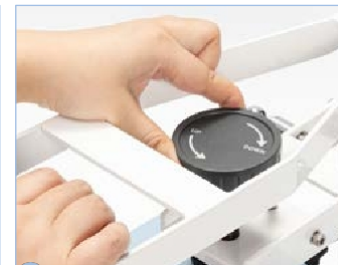
3 Nastavite pritisk tiskanja;
