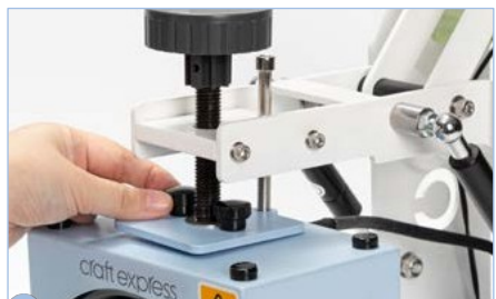
4 Pritrdite grelnik pokrova z vijaki;
