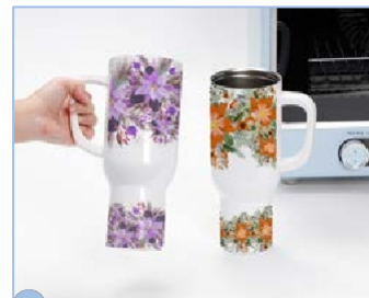
9 Ko se odštevanje konča in pečica zapiska, vzemite kozarce iz pečice. Odstranite termoplastično folijo in sublimacijski papir; preverite rezultat;
