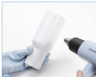
4 Uporabite pištolo za toplotno obdelavo, da se folija skrči in tesno ovije kozarec;
