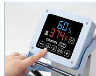
4 Vklonite stroj; nastavite čas tiskanja in temperaturo ter počakajte, da se stroj segreje;
